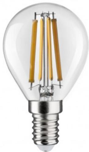
Ampoule LED E14 G45. Petite ampoule de classe A G45 idéale pour l'éclairage intérieur. LED 4W, 840 lumens et température de couleur 4000K (blanc neutre). Petite ampoule globe avec filetage E14, durée de vie de 35 000 heures et allumage en 0,5 seconde. Efficacité énergétique : A.
