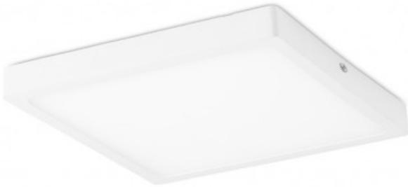
**Downlight LED** de superficie fabricado en aluminio y acrílico en acabado blanco y forma cuadrada. Estos downlights son la solución perfecta si se tiene alguna restricción de altura y no es posible instalar una luz empotrada. También proporcionan una iluminación neutra ideal para una cocina o un baño. El LED integrado no es reemplazable pero tiene una vida útil de hasta 30.000 horas.
